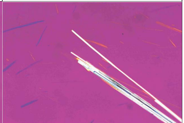
Рисунок D.20 — Мікрофотографія тремоліту SRM 1867, отримана за допомогою ПСМ, у рідині з ПЗ 1,605 — Перехрещені поляризатори з пластиною ретардації 530 нм
