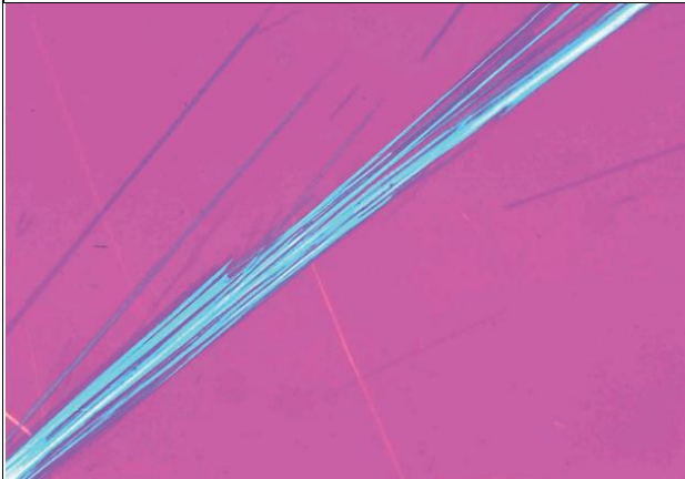
Рисунок D.29 — Актиноліт SRM 1867 у рідині з ПЗ 1,630, що спостерігають при дисперсійному забарвленні — Фіолетове волокно в положенні екстинкції
