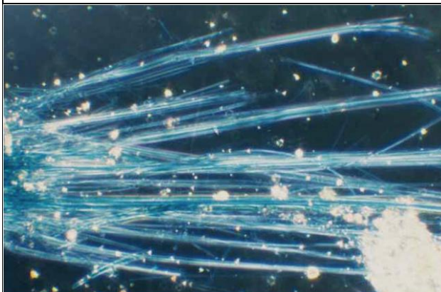
Рисунок D.15 — Крокідоліт SRM 1866 у рідині з ПЗ 1,700 — Дисперсійне забарвлення — Довжини волокон паралельні до напрямку коливань поляризатора
