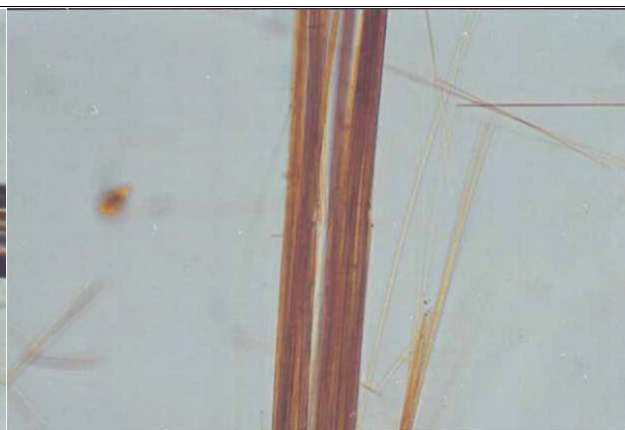
Рисунок D.10 — Нагрітий амосит у рідині з ПЗ 1,680, що спостерігають у лінійно поляризованому світлі — Довжина волокна паралельна до напрямку коливань поляризатора
