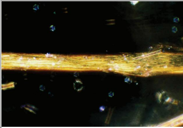
Рисунок D.37 — Тремоліт HSE у рідині з ПЗ 1,605, що спостерігають при дисперсійному забарвленні — Довжини волокон паралельні до напрямку коливань поляризатора
