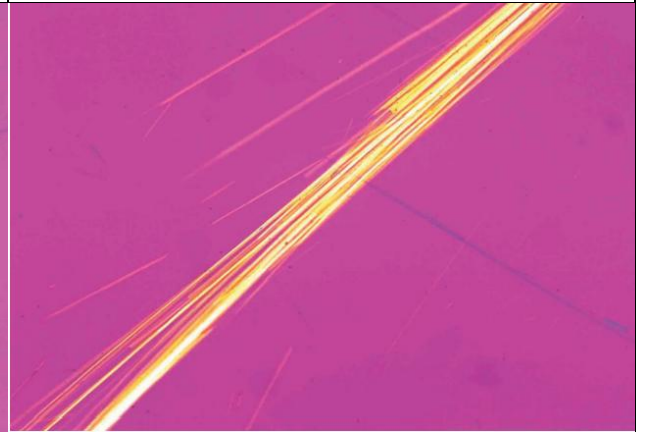
Рисунок D.30 — Актиноліт SRM 1867 у рідині з ПЗ 1,630, що спостерігають при дисперсійному забарвленні — Світло-блакитне волокно в положенні екстинкції
