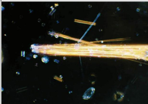
Рисунок D.45 — Мікрофотографія антофіліту HSE, отримана за допомогою ПСМ, у рідині з ПЗ 1,605 — Перехрещені поляризатори з пластиною ретардації 530 нм
