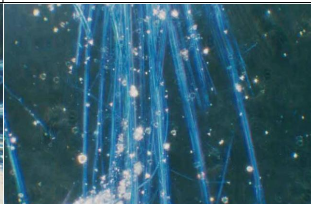
Рисунок D.16 — Крокідоліт SRM 1866 у рідині з ПЗ 1,700 — Дисперсійне забарвлення — Довжини волокон перпендикулярні до напрямку коливань поляризатора
