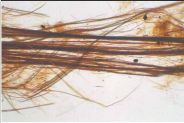
Рисунок D.17 — Нагрітий крокідоліт, що спостерігають у лінійно поляризованому світлі — Довжина волокна паралельна до напрямку коливань поляризатора
