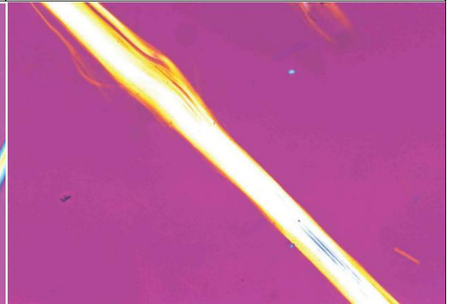
Рисунок D.34 — Антофіліт SRM 1867 у рідині з ПЗ 1,630, що спостерігають при дисперсійному забарвленні — Довжини волокон перпендикулярні до напрямку коливань поляризатора
