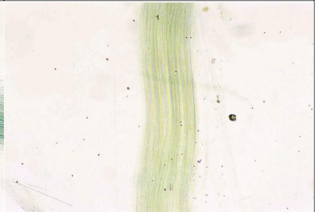
Рисунок D.42 — Актиноліт HSE у рідин з ПЗ 1640, що спостерігається при дисперсійному забарвленні — Довжини волокон, перпендикулярні до напрямку коливань поляризатора
