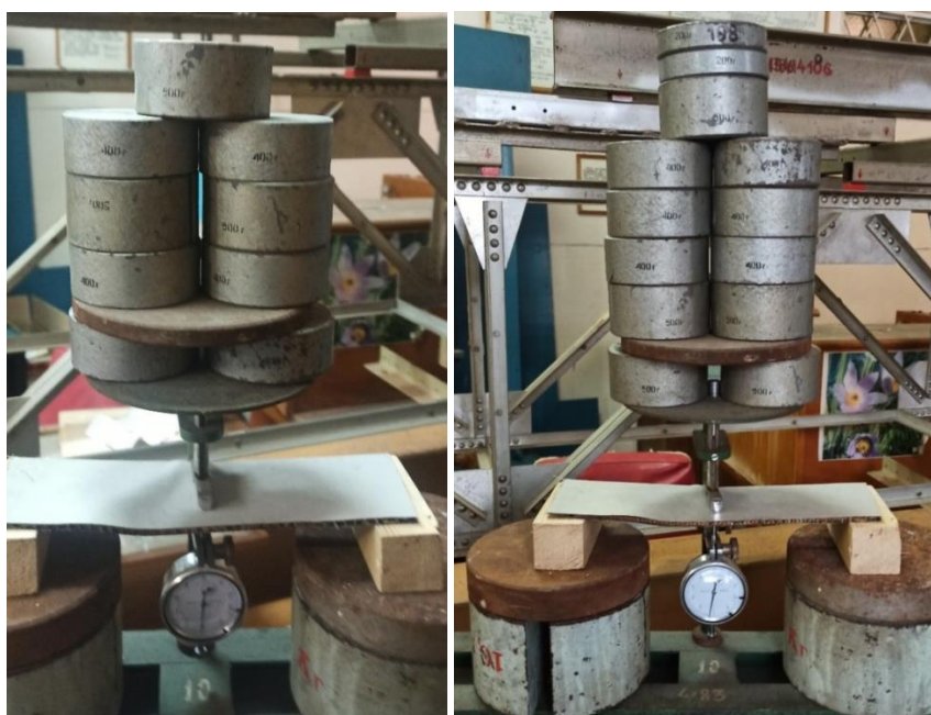
Рис 4.3. Другий етап навантаження зразка. Закритична робота балки-плити
