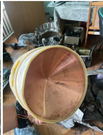
Рис. 2.11. Конічна бойова частина БпЛА “Shahed-136” і передній заряд – ударне ядро
