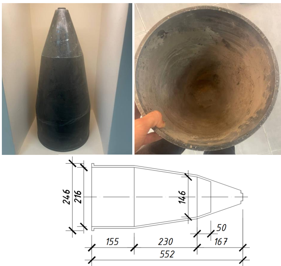
Рис. 2.12. Вигляд і типорозміри сталеві оболонки БЧ “Shahed-136”
