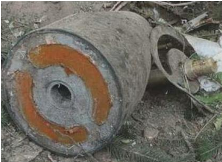
Рис. 2.11. Конічна бойова частина БпЛА “Shahed-136” і передній заряд – ударне ядро
