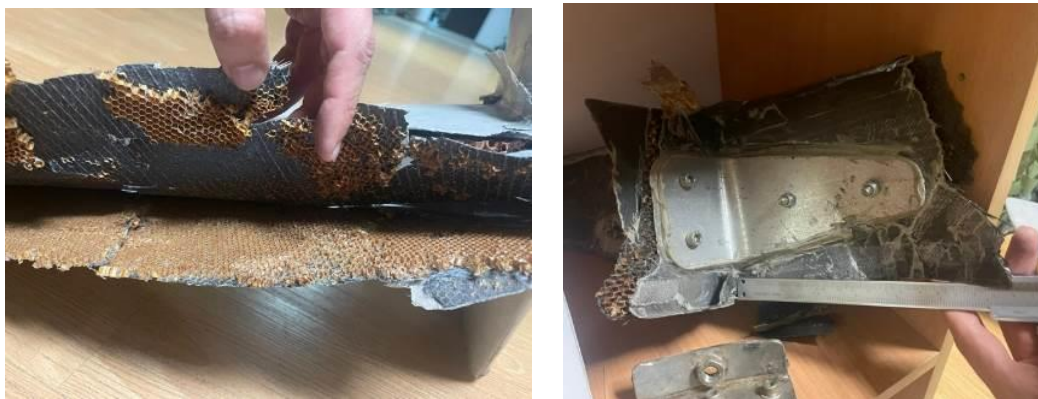
Рис. 2.9. Товщина несучої обшивки та кутикові металеві елементи кріплень панелей БпЛА “Shahed-136”
