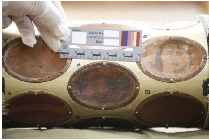
Рис. 2.10. Бойова частина БпЛА “Shahed-131” із комбінованою, осколковою мультікумулятивною дією
