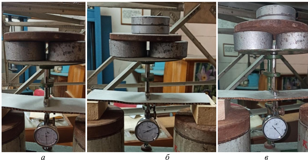
Рис. 4.2. Навантаження 2,35 кг на початок утворення хвилі у верхній стиснутій обшивці зразка – а; перший етап навантаження 2,75 кг – утворення хвилі у верхній стиснутій обшивці, діагональний характер відшарування верхньої обшивки – б; зростання прогинів після доби витримування під навантаженням – в
