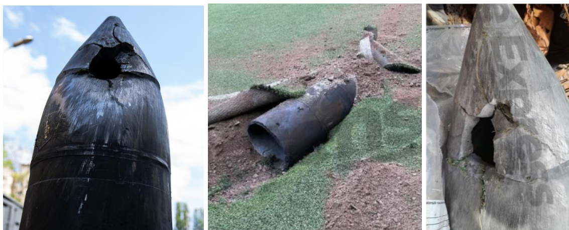
Рис. 2.2. Вигляд БЧ збитої 04 травня 2023 року над Києвом ракети “Кинджал” з оболонкою із титанового сплаву 20...24 мм завтовшки [8]
