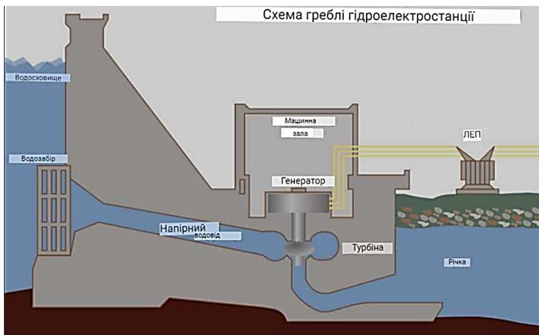
Рис. 1.6. Принципова технологічна схема роботи гідроелектростанції
