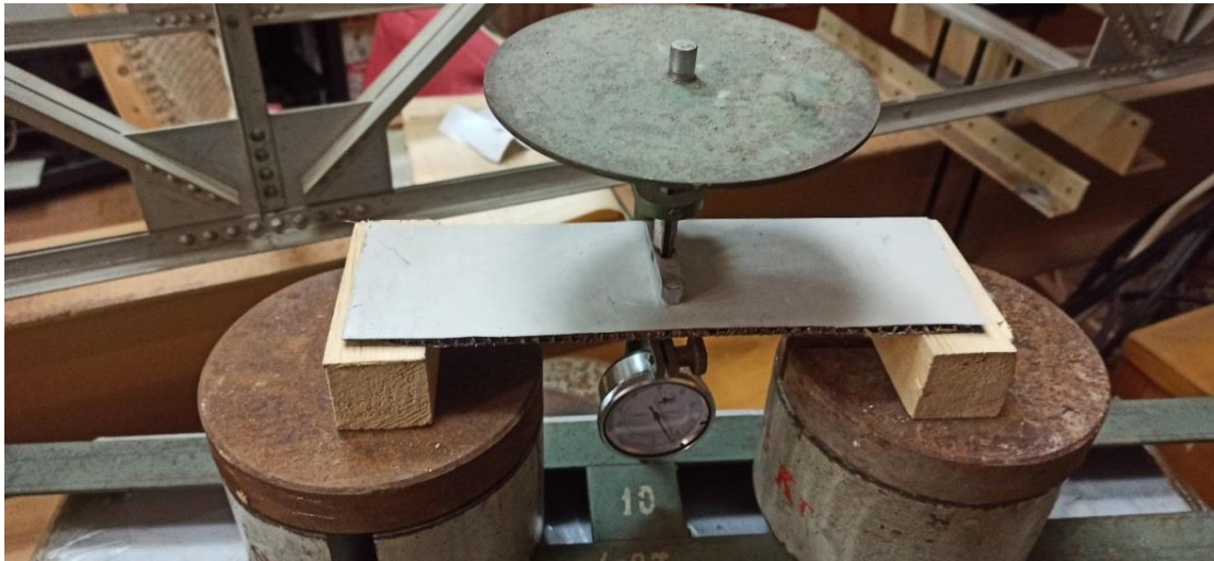
Рис. 4.1. Експериментальна установка до навантаження з початковими показниками датчика годинникового типу
