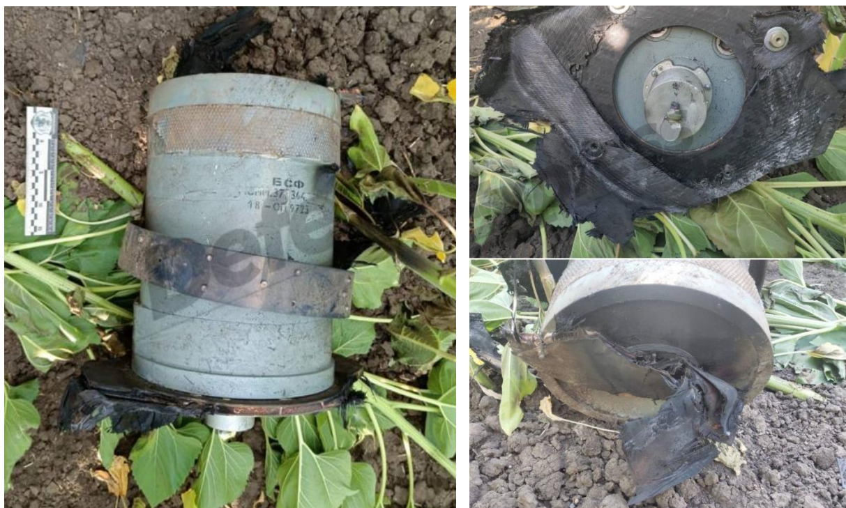
Рис. 2.13. Наслідки розриву БЧ “Shahed-136”: а – воронка та розміри осколку від із місця вибуху; б – новий тип БЧ, знайдений у 2023 році
