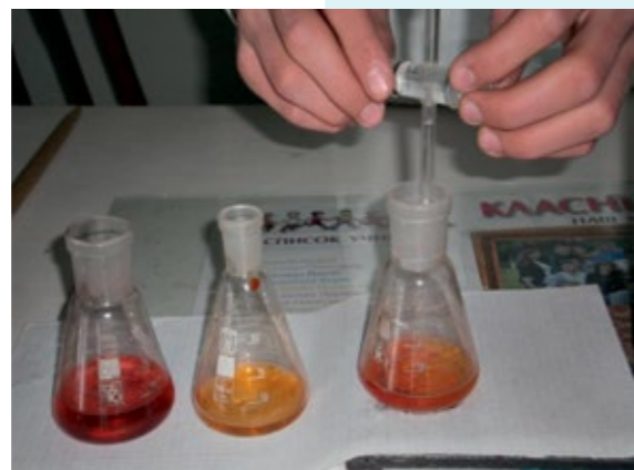
Кисотно-основне титрування дослідних зразків: проби до (центральна) і після (крайня ліва) титрування
